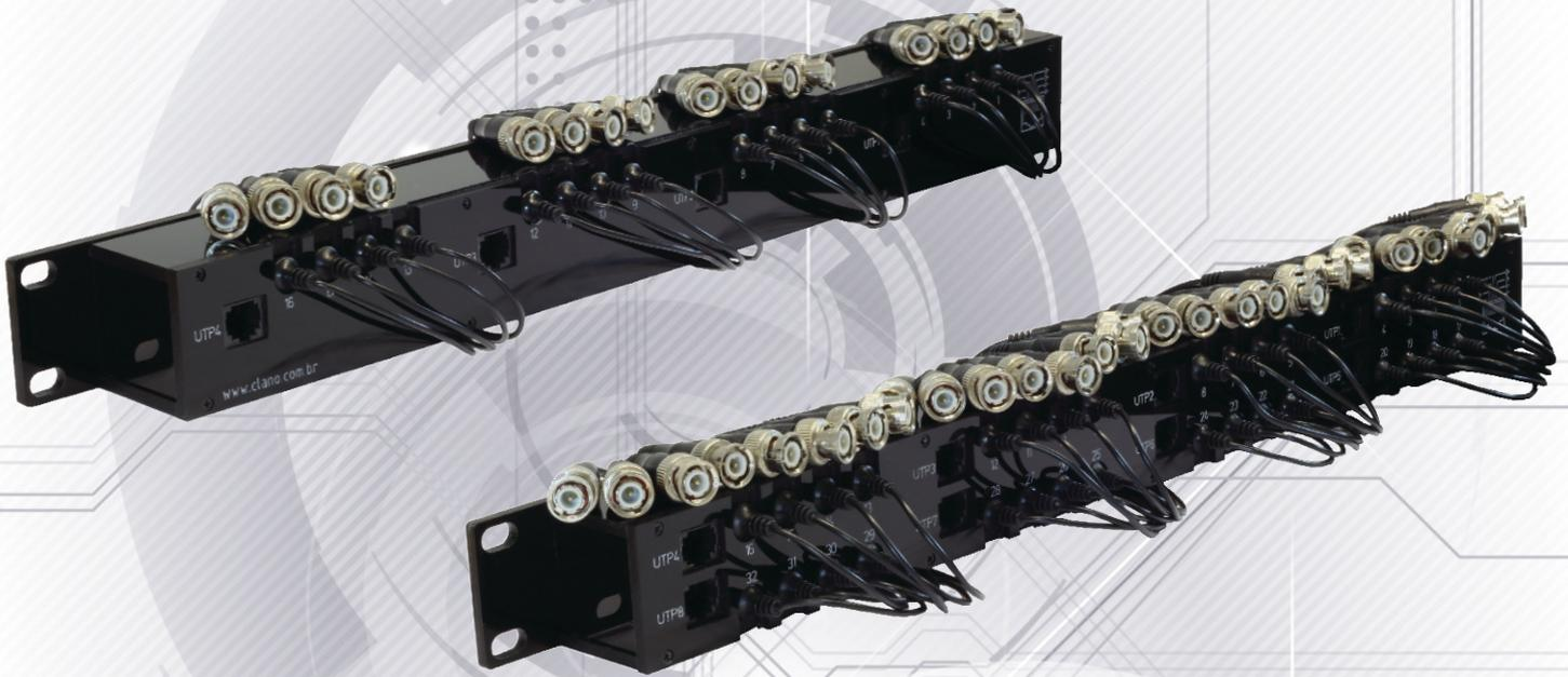
**Converte o sinal de vídeo de 16 ou 32 câmeras de segurança para serem usadas com cabos UTP, a uma distância de até 600 metros, sem o uso de alimentação. Já vem com cabos e conectores BNC para ligar ao DVR.**
